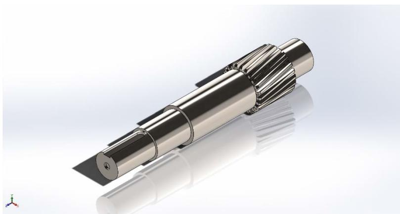
Рисунок 15 – Модель вала с выбранным материалом
