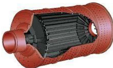
Рисунок 1 - Барабан шаровой мельницы [1]
