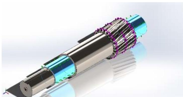
Рисунок 17 – Вал с креплениями в зоне зацепления подшипников
